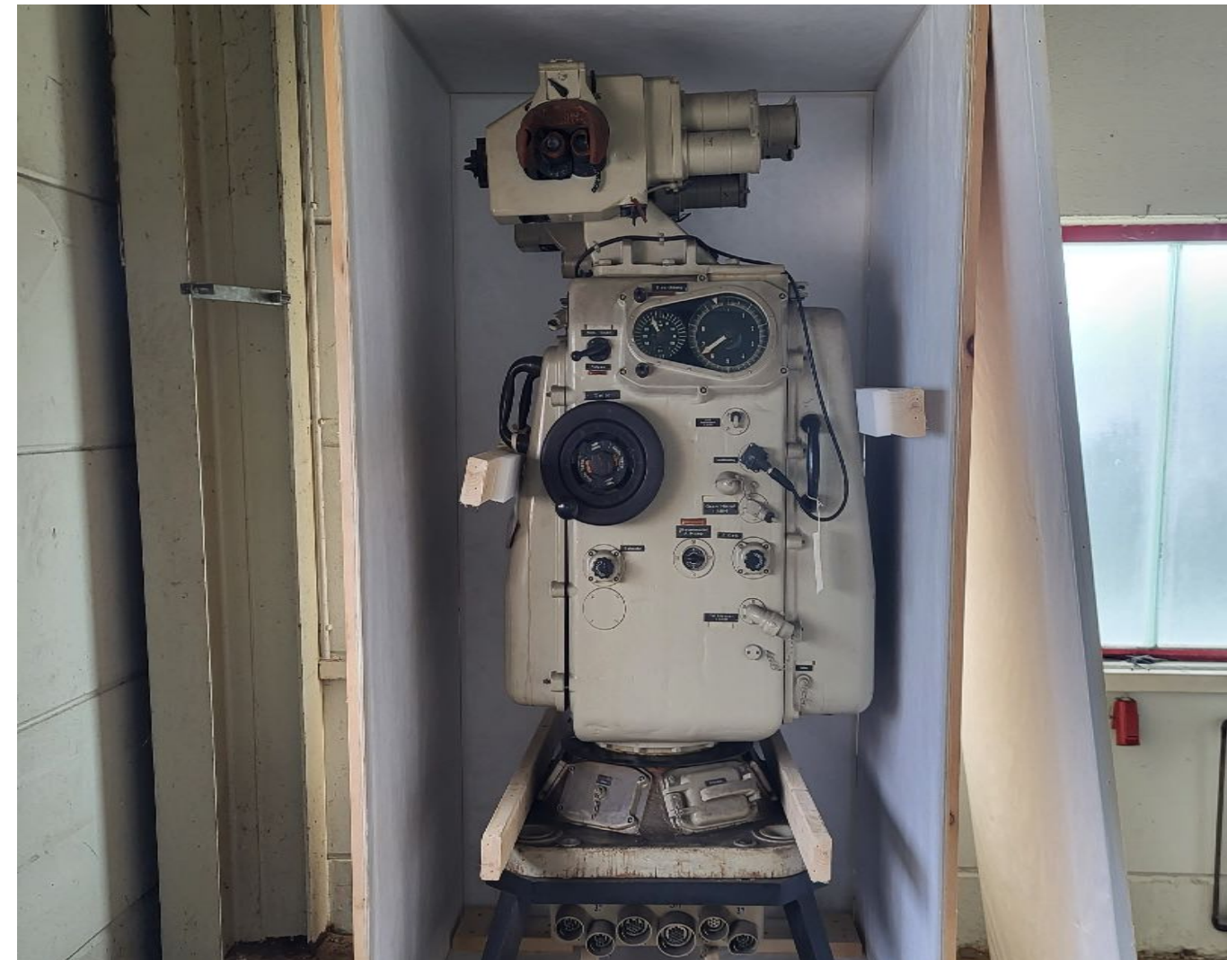
ZIELMESSGERÄT DER HAUPTBEWAFFNUNG SCHWERER KREUZER PRINZ EUGEN
